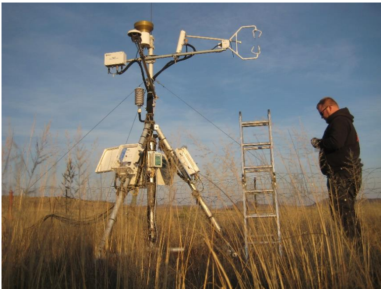
Bild 5 Wartungsarbeiten am Treibhausgasmessturm in The Karoo, Süd-Afrika © Thünen-Institut AK, J.Ch. Jüdt
