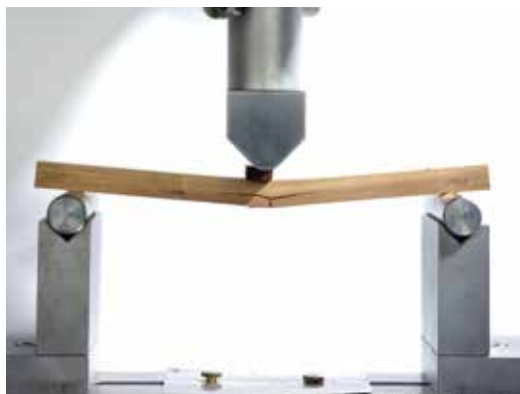
Biegeprobe Holz: »Prüfung der Biegeeigen- schaften gemäß DIN 52186«
