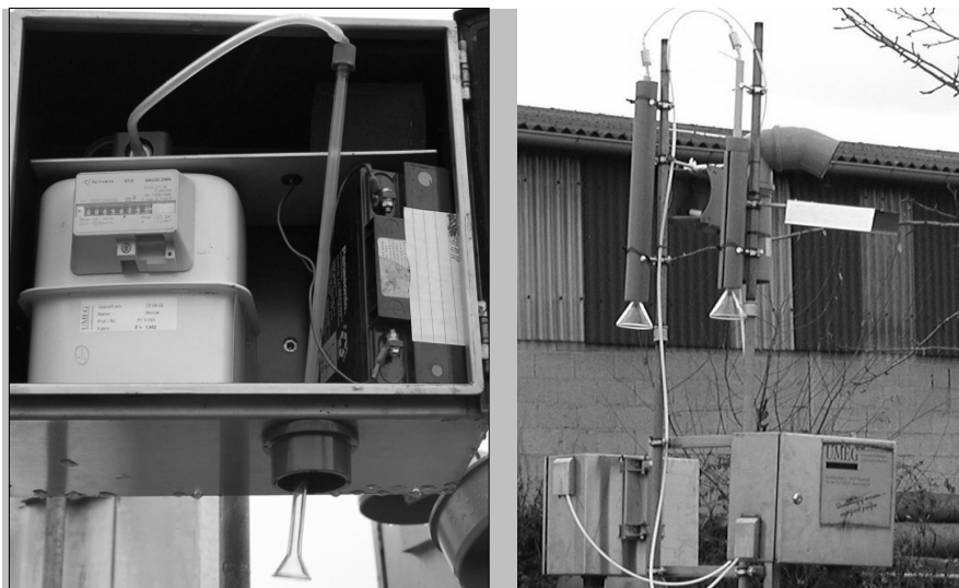
Abbildung 8: Zylindrische Denuder der Bauart NUPS.
