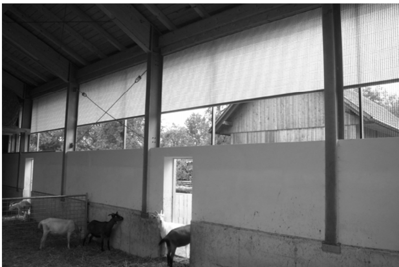
Abbildung 2: Windnetze im Ziegenstall sichern gute Lüftung
